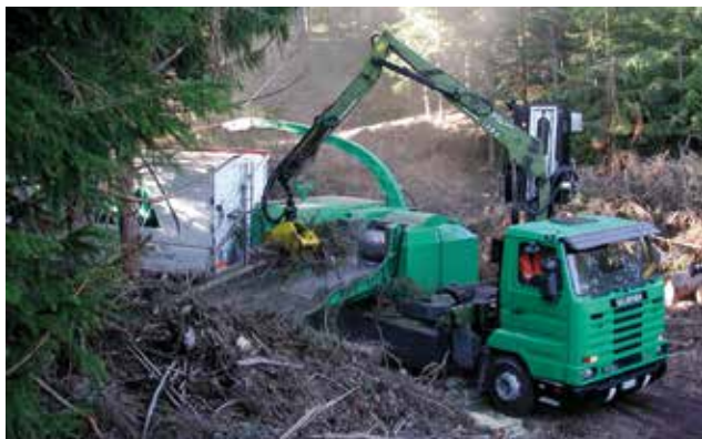
Fig. 7 - cippatrice dotata di cabina e gru incorporata
