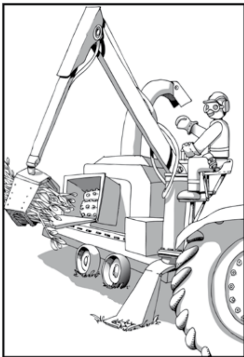
Fig. 25 - allacciare sempre la cintura di sicurezza e indossare i DPI prescritti
