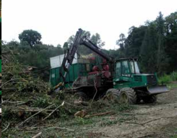
Fig. 13 - esempi del canale di alimentazione in una cippatrice montata su camion (sinistra) e su forwarder (destra)
