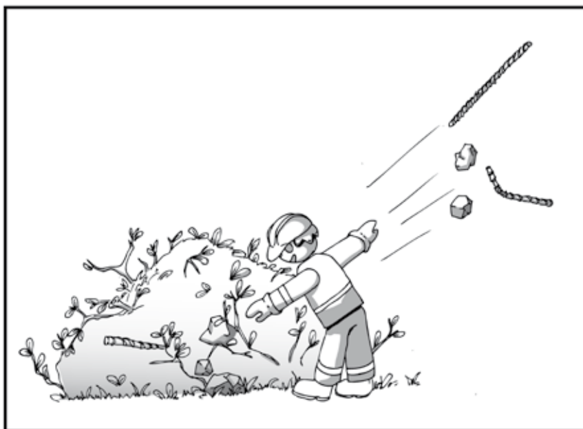
Fig. 23 - la presenza di materiale estraneo potrebbe danneggiare le lame
