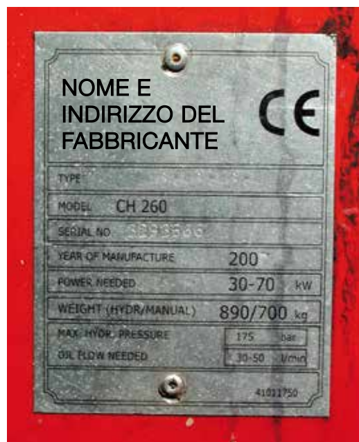
Fig. 15 - esempio di marcatura CE applicata su una cippatrice
