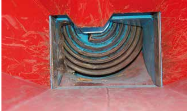
Fig. 5 - particolare della vite senza fine
