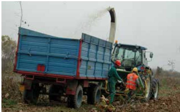
Fig. 6 - alimentazione manuale della cippatrice
