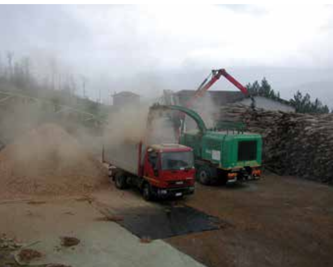
Fig. 17 - la cippatura di legname molto secco genera una grande quantità di polvere
