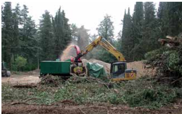
Fig. 8 - cippatrice alimentata da un caricatore separato
