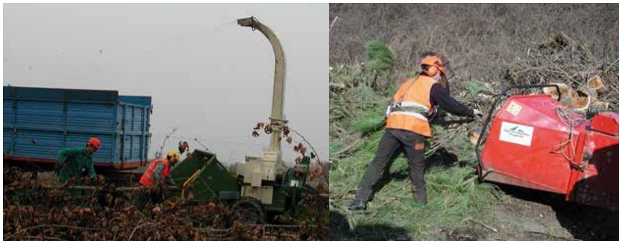
Fig. 12 - cippatrice alimentata manualmente e dotata del comando di arresto dell'alimentazione (barra gialla nella figura a sinistra e barra nera in quella a destra)
