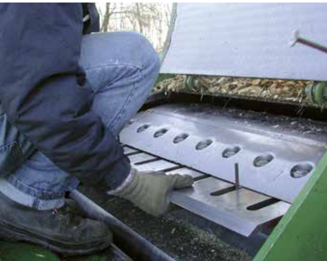
Fig. 19 - nel cambiare i coltelli, maneggiarli indossando i guanti
